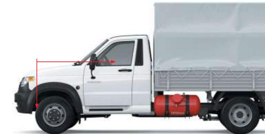
Капотная компоновка обеспечивает большую безопасность водителя при лобовом столкновении
